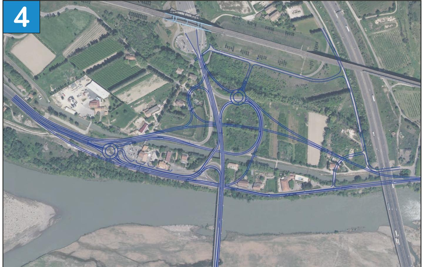
Création d'un giratoire Nord-Est, d'une bretelle directe Caumont -> Bouches-du-Rhône et d'un nouvel axe Est -> Ouest au Nord du canal pour dissocier les sens de circulation sur la RD900 : sens Est -> Ouest au Nord du canal et sens Ouest -> Est en bord de Durance sur la RD900 existante
