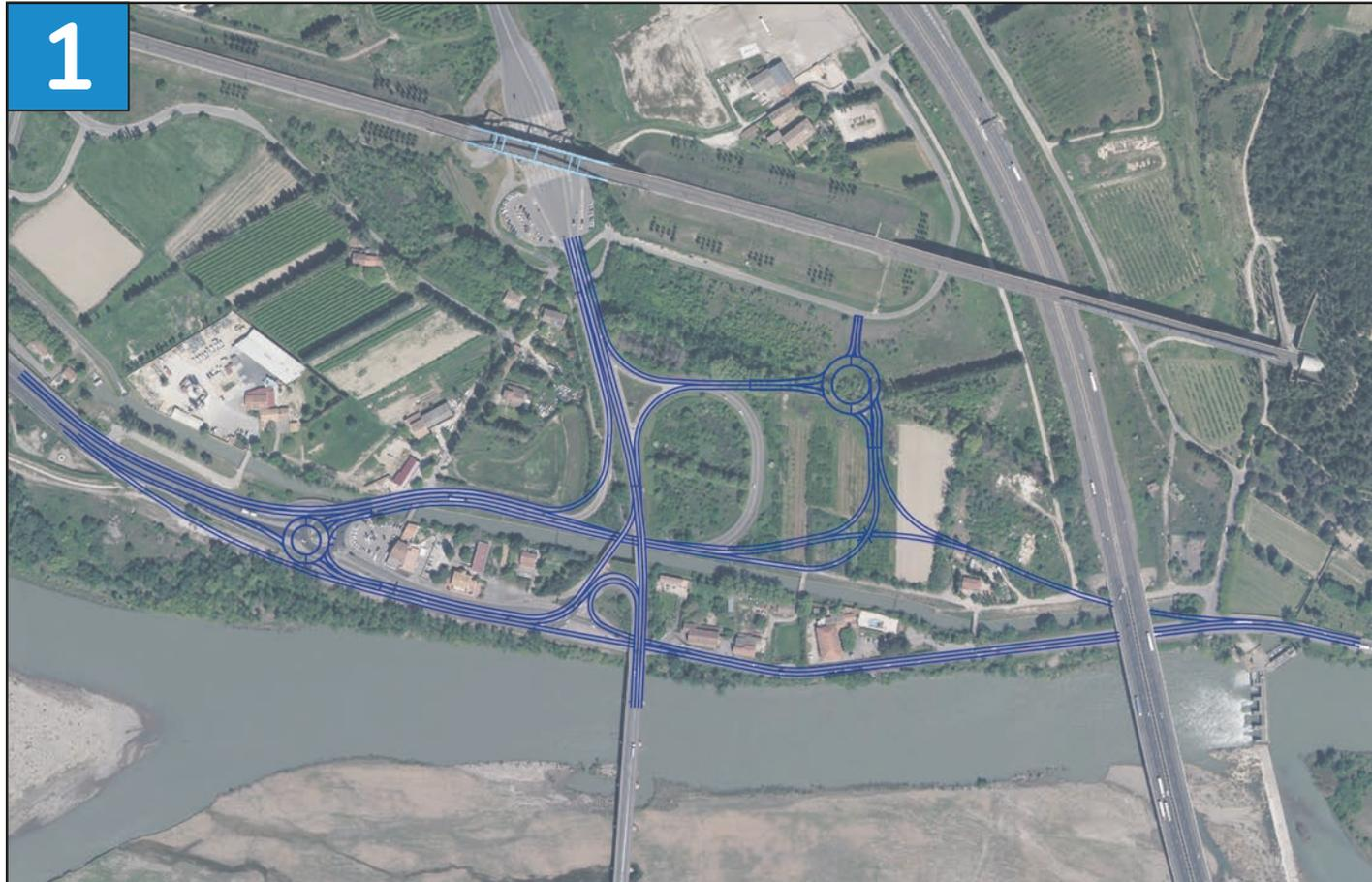
Création d'un giratoire Nord-Est et d'un nouvel axe Est -> Ouest au Nord du canal pour dissocier les sens de circulation sur la RD900 : sens Est -> Ouest au Nord du canal et sens Ouest -> Est en bord de Durance sur la RD900 existante
